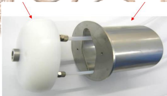
Ілл. 6, монтаж форсунки
